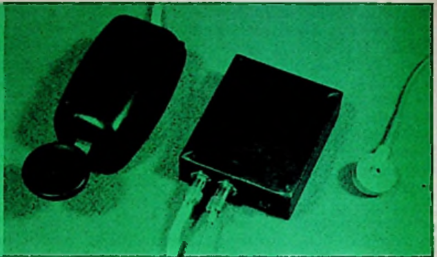
Afb. 1. Bedrijfsklare morse-inrichting met sleutel, toongenerator en oortelefoon.
